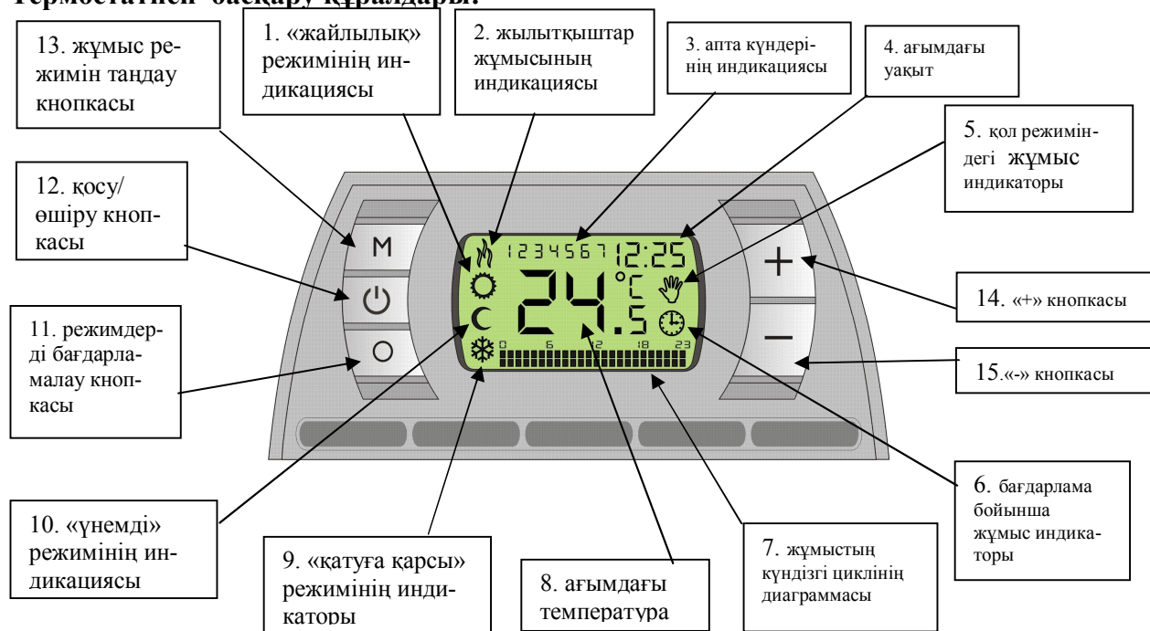
Сурет-2. Электр жылытқышпен басқару құралдары.
