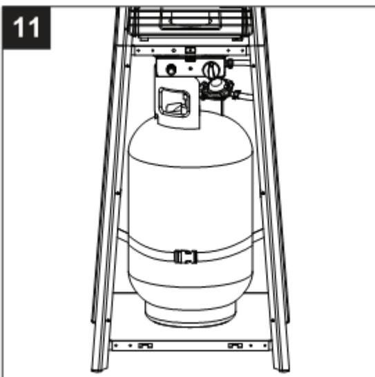
11. Подключение трубы для пропана (только для пропана).
