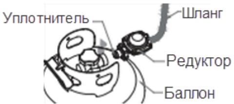
*Шланг/Подключение редуктора и Редуктор/Подключение баллона*
