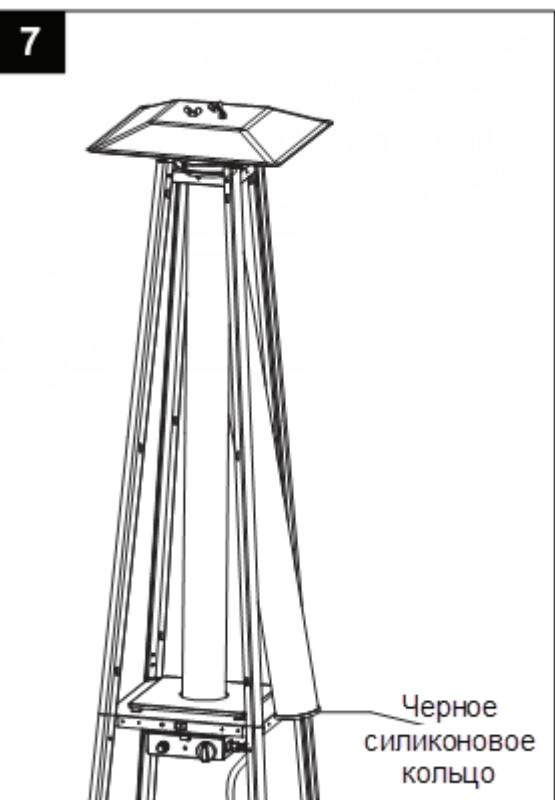
7. Аккуратно установить стеклянную трубку, приподнимая и вставляя ее через центральное отверстие в верхней пластине. Удостоверьтесь в том, что черное силиконовое кольцо прилегает к нижнему краю стеклянной трубы, как показано. Проведите стеклянную трубку через отверстие в крышке нижней пластины на среднюю пластину. Проверьте положение трубы, удостоверьтесь в том, что стеклянная трубка установлена правильно, полностью закрывая центральное отверстие средней пластины.
