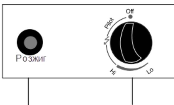
Розжиг      Вращаемая ручка управления (плавная регулировка)
