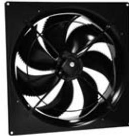
**Двигатель:** AW оборудованы электродвигателями с внешним ротором с регулируемой скоростью вращения. Двигатели оснащены встроенными термоконтактами с выводами для подключения к внешнему устройству защиты от перегрева.
