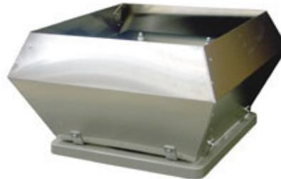
**Конструкция:** Корпус DVC выполнен из стойкого к воздействию морской воды алюминия. Рама изготовлена из оцинкованной стали с защитным порошковым покрытием. Рабочее колесо вентиляторов типоразмером 190 и 315 изготовлено из полиамида PA6. У DVC 355-630 рабочее колесо выполнено из алюминия в морском исполнении. Вентиляторы серии DVC имеют вертикальный выброс воздуха.
