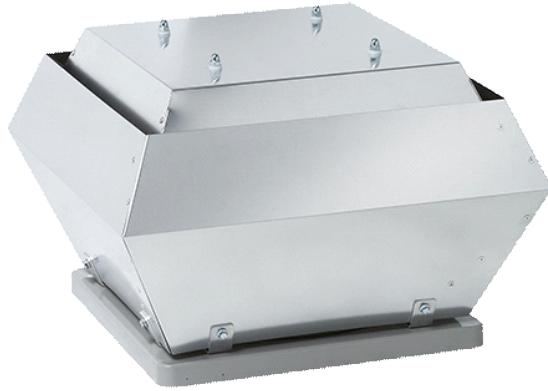
**Двигатель:** Вентиляторы DVC оборудованы энергосберегающими высокоеффективными ЕС-двигателями с внешним ротором. Электродвигатели с рабочим колесом с загнутыми назад лопатками начиная с типоразмера 355 монтируются на высокоеффективных виброизоляторах. Двигатели оснащены электронной системой защиты от перегрева электродвигателя, дополнительные средства защиты не требуются.
