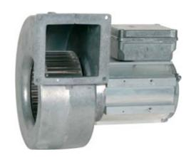
**Двигатель:** Вентиляторы EX оборудованы 1-но или 3-х фазными электродвигателями и рабочим колесом с загнутыми вперед лопатками. В 1-фазных вентиляторах используются конденсаторы электродвигателя, помещенные в песок. Для защиты двигателя от перегрева необходимо подключить внешнее устройство защиты (MSEX).
