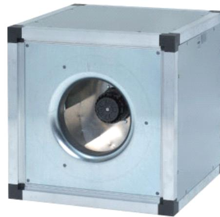
**Конструкция:** Самонесущий корпус вентиляторов серии MUB изготовлен из алюминиевого профиля с изолированными резьбовыми каналами, позволяющими избежать конденсации. Уголки корпуса изготовлены из армированного полиамида РА6. Двойные боковые панели изготовлены из оцинкованной стали со слоем изоляции из негорючего стекловолокна толщиной 20 мм.
