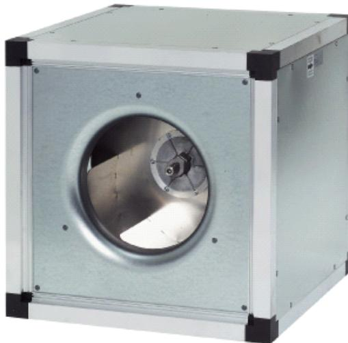
**Конструкция:** Корпус MUB состоит из алюминиевого каркаса с ударостойкими пластиковыми уголками, усиленными стекловолокном, и съемных панелей с двойными стенками из оцинкованной листовой стали. Во избежание конденсации в профиле имеются изолированные резьбовые каналы. Панели имеют изоляцию из минеральной ваты толщиной 20 мм. MUB поставляются в прямоточной конфигурации крепления панелей. Эта конфигурация легко изменяется для подачи воздуха перпендикулярно всасываемому потоку.
